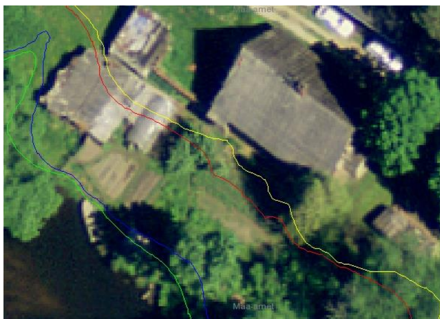
Joonis 2.9. Veski kinnistu (87202:002:0053) hoonestuse (vt ka joonis 2.8, alumine parem foto) juures abs kõrgused – 49,0 (49,16, EH2000; kollane) m, 48,9 (49,06, EH2000; punane) m, 48,4 (48,56, EH2000; sinine) m, 48,3 (48,46, EH2000; roheline) m. Alus: Maa-amet, 2013 (sh ST-B2-2601).
