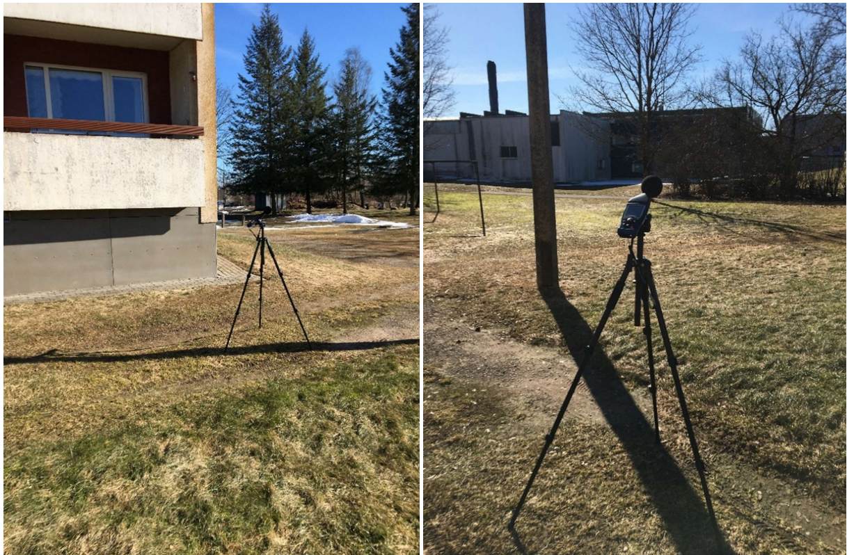
Joonis 22. Mikrofoni positsioonid POS 21 (vasakul) ja POS 22 (paremal)
